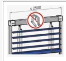
Construction de stores autoporteuse
