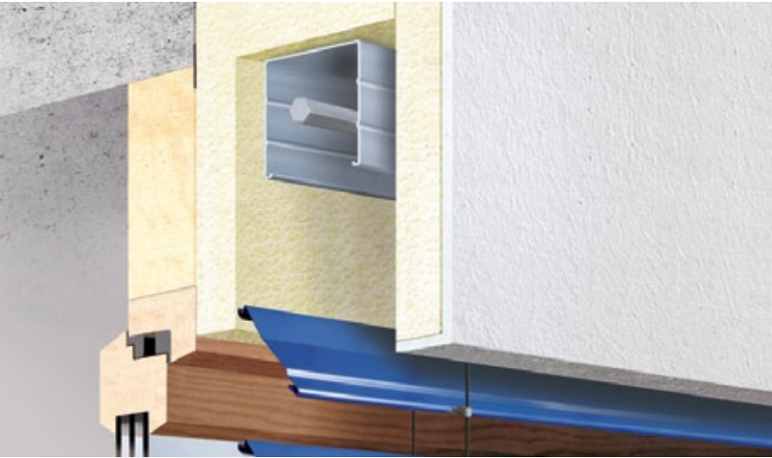
Coupe horizontale pour commande par treuil
